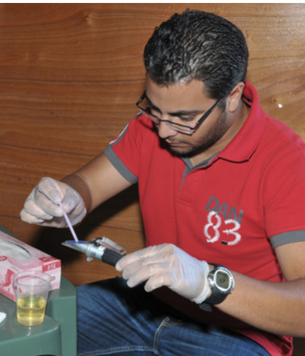
Ein DAN Europe Forscher führt die Messung der Dichte des Urins während eines DAN Forschungsereignisses durch. Dieser Test bestimmt das spezifische Gewicht des Urins, welches vom Hydratationszustand des Tauchers abhängt.
